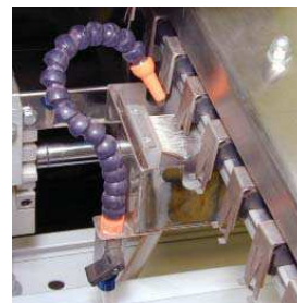
En option système de nettoyage des doigts équipé d'une buse et d'une brosse
