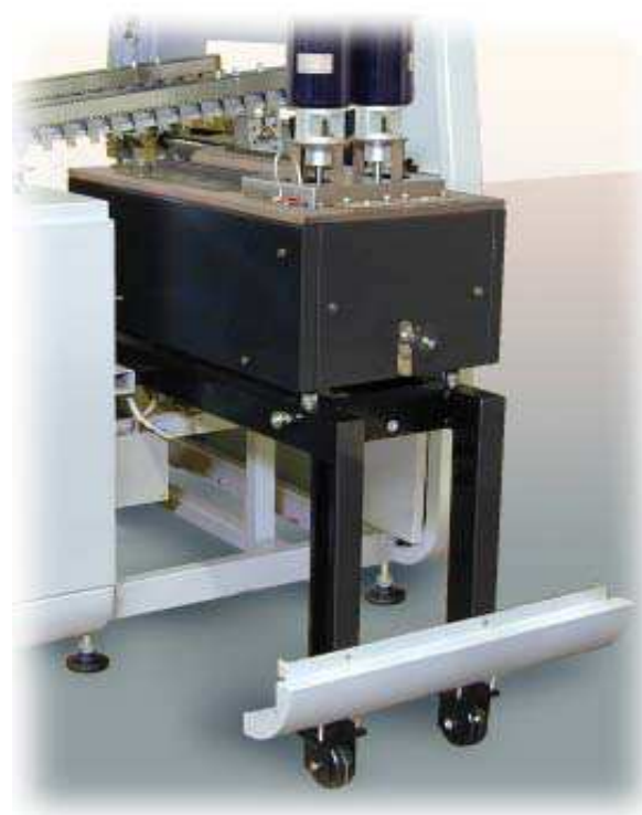
Sortie du pot de soudure motorisée
