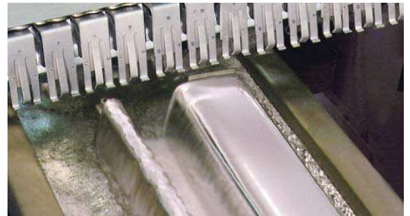
Vague CMS et vague laminaire pour composants traversant
