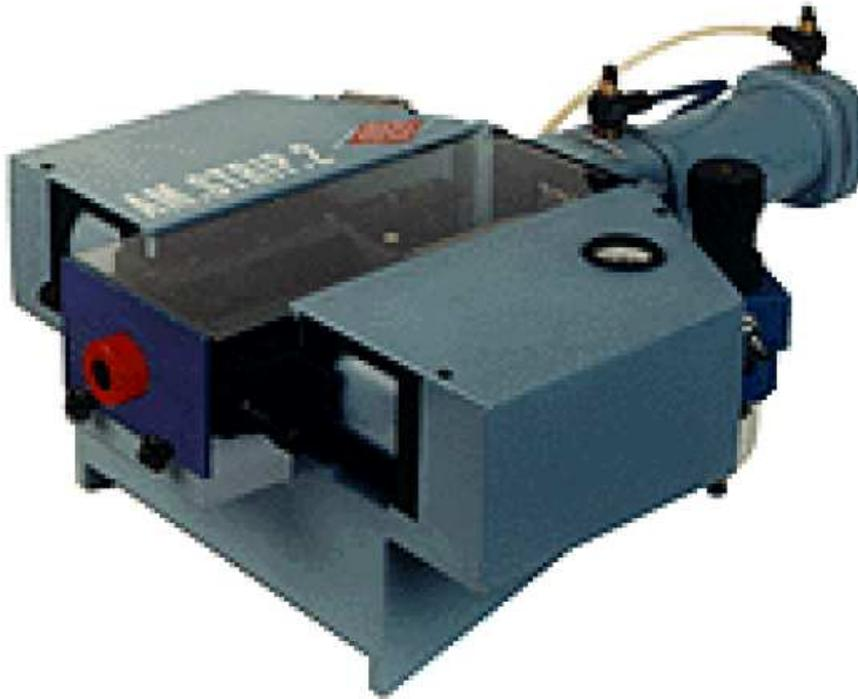
Les machines de la Série PAM-STRIP sont idéales pour les applications de dénudage difficiles. Ces unités d'établi permettent à l'opérateur d'insérer l'extrémité coupée d'un fil ou câble et de déclencher l'opération de dénudage ou dégainage par l'intermédiaire d'une pédale.
