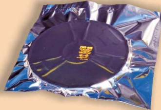
Sac barrière scellé avec une légère dépression
